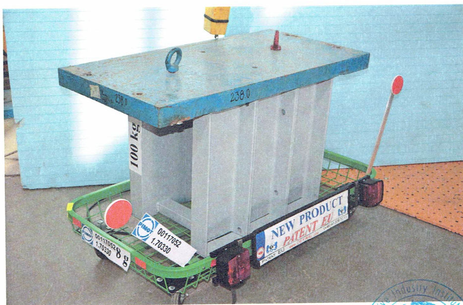
Fot. 4. Kosz bagażowy TRAGARZ jako wózek transportowy – obciążenie badawcze 338 kg – nie stwierdzono trwałych odkształceń wózka
